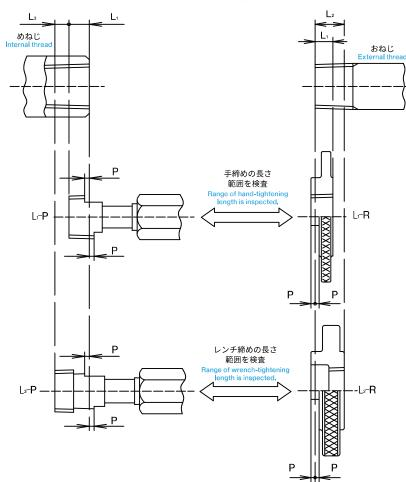
注)ゲージのノッチ(切欠き)の記号 P は、ピッチを表す。 Note) Symbol P of notch of gauge represents pitch.
